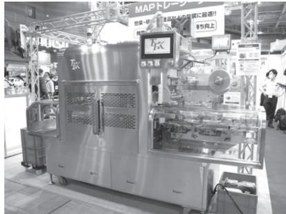
「創意工夫」「技術練磨」「未来創造」を社是とし、食品向けのパックシーラーを設計・製造・販売するエーシンパック工業。今回のFOOMA JAPANで同社が注力していたのはMAP包装機だ。容器とフィルムがセットされたチャンパー内部全体を真空引きした後にガスを封入し、シールとトリミングする同機は、ガスフラッシュ式よりも高いガス置換率を誇る。オプションで、フィルムと容器にミシン目を入れる装置も付属可能。「今回の出展では一機種一製品の包装だけではなく、部品のサイズチェンジを行うだけで様々なサイズのトレーに対応できる使い勝手のよさをPRしたいですね。海外からのお客さまのお問い合わせも多く、FOOMA JAPANの集客力の高さに改めて驚きました。これを売り上げにつなげたいですね」(担当者)。
