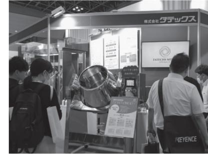
静岡市に本社を置くタテックスは、創業30年の業務用オートミキサーメーカー。今回は粉体・固体・液体に対応する人気製品2種、シンプルでスタイリッシュな「スタンダードミキサー」と、昇降アシストで使い勝手のよい「クライマーミキサー」を展示。注目を集めていたのは、「ドラムの回転と揺動、混合羽根による拡散効果で、すばやく均一に混ざる“革新3分混合”という回転揺動拡散タテックスミキサーの技術。ブースではパネルを設置し、容器固定の攪拌型ミキサーの混合精度を比較。「水洗いが可能なオールステンレス製で、なおかつドラムの間口が広く洗浄作業がしやすい」(担当者)というミキサーの構造も、食品加工の現場で働く人たちの興味と関心を引きつけていた。
