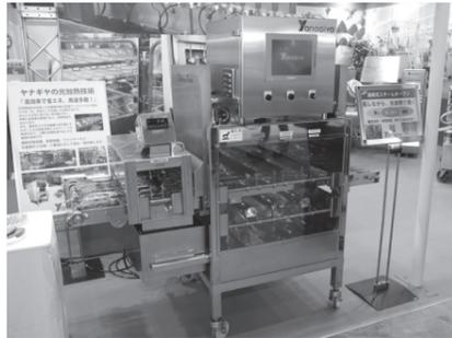
光加熱技術は、加熱した石英管内部の高温フィラメントから放出される光を熱源として利用した加熱方法。従来のガス式高温加熱フライヤーの場合、輻射熱や二酸化炭素の排出により作業環境は悪化しがちだが、光加熱技術なら高効率電気式加熱により温度の立ち上がり早い上に、二酸化炭素の排出はゼロ。輻射熱による工場内の温度上昇も防げて、作業環境が大きく改善できる。ブースには、自由にカスタマイズできるオートフライヤー、鍋底を全面均一に加熱するFPH(フラットプレートヒーター)フライヤー、蒸しながら光加熱で焼く連続式スチームオープンなどの光加熱技術を使ったデモ機も展示されていた。
