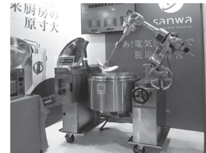
静岡市に本社を構える三和厨理工業は、業務用電化厨房のパイオニア的存在。今回は、煮込み料理、炒め物・ボイルなどの調理をマルチにこなせる「電気回転釜」を紹介。「他の熱源と比較して操作性・安全性・快適性が向上し、CO<sub>2</sub>削減にも貢献」するとして同製品を積極的にアピールしていた。電気回転釜の特長は「衛生面に優れ、錆にも強いステンレス(SUS304)を採用」「熱源に熱伝導性の高い特殊アルミモールドヒーター、釜底に12mmのクラッド鋼板を使用し、全面均一加熱を実現」「火を使わないため、排熱も削減。厨房内の温度を快適に保てる」こと。さらに「熱の放出量が少ないため、調理員が釜に近づいて調理作業できるようになり、火傷の危険性や腰への負担が軽減されるようになった」(担当者)と説明してくれた。
