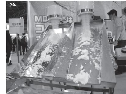
金属などの表面改質技術をキーテクノロジーに、粉体の付着や目詰まりなどによる諸問題を解決に導くサーフテクノロジー。ブースを2分割し、コーポレートカラーのオレンジ色に染めた一角ではMD処理をアピールしていた。MD処理とはコーティングではなく、金属の表面に微粒子を超高速で衝突させ「目的に応じた表面形状を作る」技術。滑り性向上と付着を抑制することで設備の洗浄時間短縮や、細菌・カビ・ウイルスの増殖抑制、歩留まりの向上などさまざまなメリットがあるという。もう一方のブルーの一角ではPFAS規制対策として、PFASフリーで高い非粘着・耐熱・耐摩耗性を誇るコーティング技術「Infinity530」を展示。来場者がびっくりなしに訪れて高い関心を示していた。
