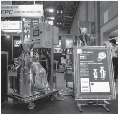
産業用粉砕機・製造加工機的设计・製造・販売を手掛けるグローエンジニアリングは、大規模プラントで培ったハイテク技術を応用した、独自の新技术「EPCテクノロジー」を紹介。「イージーポイントコントロールGM-EPC」の実演によって、「グラインダー粉砕機（石臼式粉砕機）の世界に革命を起こす」と宣言する同社は、その実力を惜しみなく披露していた。クリアランス（隙間）の調整は、3ミクロン（3/1000mm）単位。
