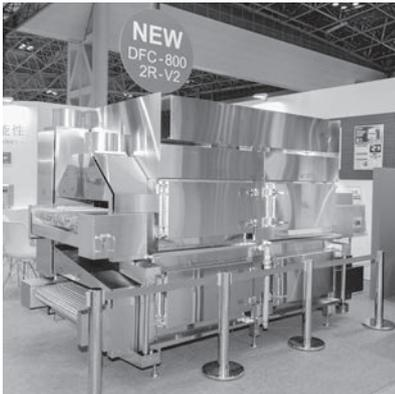
FOOMA JAPANへの出展が10回を超える、スチームに特化した調理機器メーカーの直本工業は、過熱水蒸気オーブン「DC Conveyorシリーズ」の最新モデルを初公開した。このDFCシリーズは、同社独自のスーパーヒーターにより、最高400℃の過熱水蒸気を生成できるのが特長。凝縮熱で旨味を閉じ込め、均一でスピーディーに調理するほか、満遍なく過熱水蒸気を噴射することで高い除菌効果も期待できる。またスチーム内部を無酸素状態にすることで、旨味や栄養を損なわず、ジューシーで色味を鮮やかに仕上げるができるという。新製品の「DFC-800-2R-V2」は、上下2段構造を採用することで焼成能力を従来比約2倍に向上。デモンストレーションでは、皮にはしっかり焼き目がつき、中は柔らかいサバの塩焼きや、冷めてもおいしさが持続するグリルチキンなどが振る舞われ、仕上がりのよさを来場者が実感していた。このほか「スチームフードストッカー」や冷凍麺を解凍・加熱する「Si-Pronto」などが注目を浴びていた。
