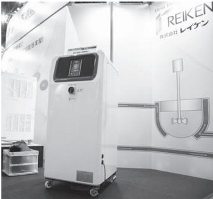
水や油などを媒体として循環させ、あらゆるものを温めたり冷やしたりすることで品質向上をサポートする温調装置。その専門メーカーであるレイケンは、水や油のほか、過熱水蒸気、ブライン、フッ素など、さまざまな物質を媒体とする温調装置を製造販売している。
