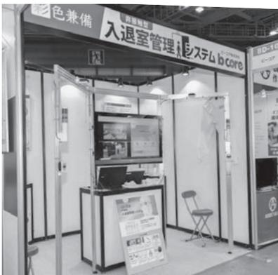
初出展となるビーコアは、自社開発の自動認識コード「カラービット」と、AIカメラを活用した入退室管理システム「彩色兼備」をPRしていた。カラービットは、バーコードや2次元コード、あるいはRFIDやビーコンでは対応が難しい場面でも使用できる、独自性の高い技術だという。食品工場では、作業員が帽子やマスクを着用しているため、顔認証やICカードによる入退室管理が難しく、カラービットがその解決策となる。
